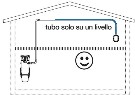
**Il tubo flessibile si sviluppa solo sul livello orizzontale della predisposizione, limitando lo sviluppo verticale al solo collegamento della presa Pratico Smart.**
