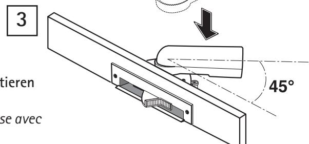
Monter le raccord sur la prise avec l'inclinaison indiquée
