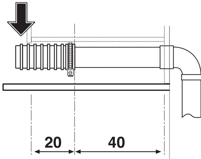
Prolongue la línea de aspiración hasta 2/3 del espacio técnico y conecte la manguera de manera que pueda salir por el frente del mueble, de la manera indicada
