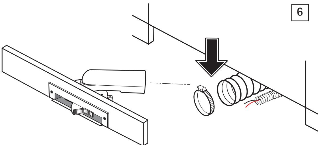
Conecte el racor para Vac Pan al extremo del tubo que sale del mueble y apriete la abrazadera
