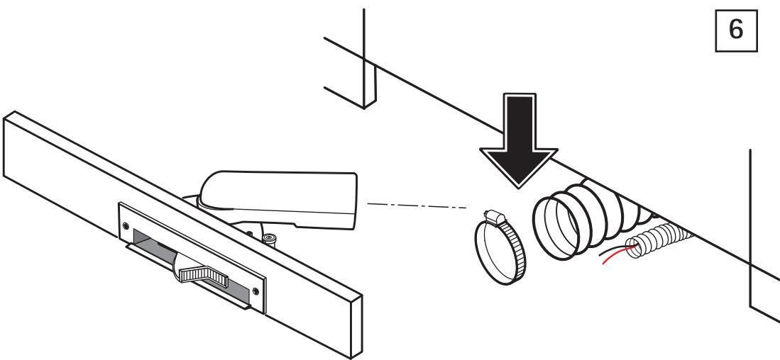
Den Anschluss für die Vac Pan Saugsteckdose an das Schlauchende anschließen, das aus dem Möbel kommt, und den Binder anziehen
