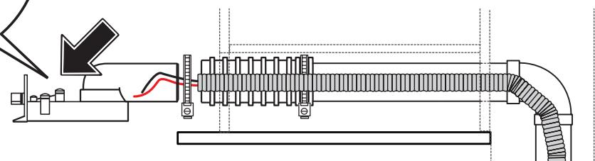
Raccorder la ligne des prises 12V aux bornes de la prise Vac Pan comme indiqué
