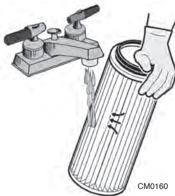
Laver la cartouche filtrante à l'eau courante avec un jet d'eau pas trop fort.
