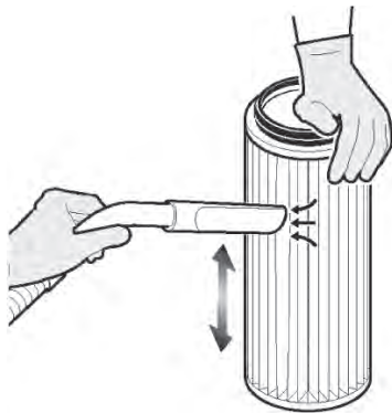
Die Filterpatrone herausziehen und mit Hilfe der Saugzentrale selbst die Reinigung vornehmen, indem man das Zubehör Eckenbürste
