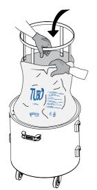
5 - reinserire il cono convogliatore assicurandosi del corretto alloggiamento della guarnizione in gomma (0)
